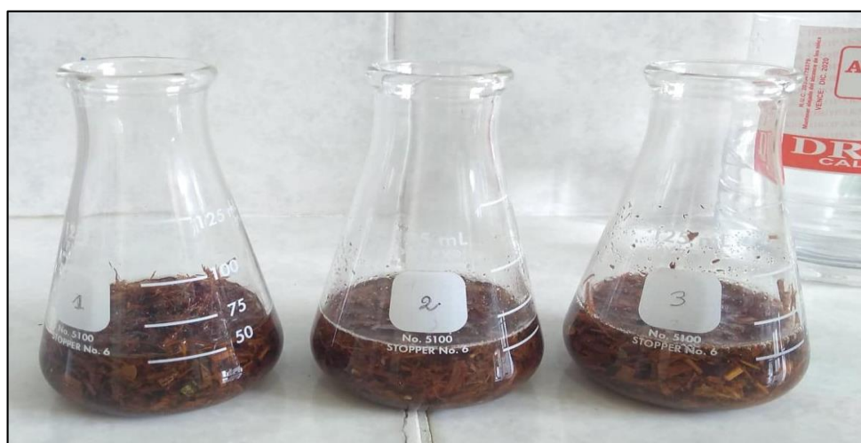
Anexo 05. Determinación de sustancias solubles extraíbles de la corteza de Uncaria tomentosa (uña de gato).
