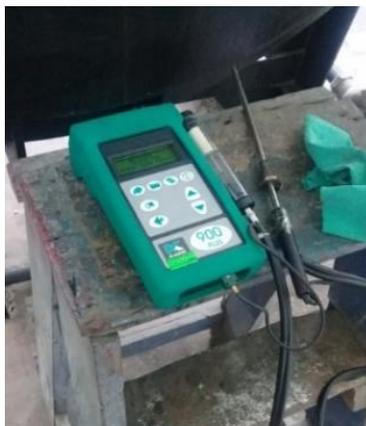
Figura N° 28. Analizador de gases
