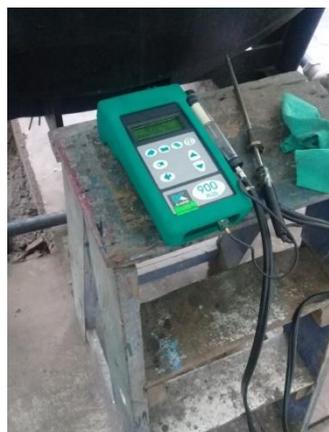
Figura N° 44. Analizador de gases
