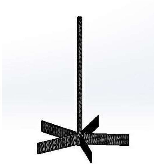
Figura 22. Mallado de conjunto alabes – eje del agitador mecanico Fuente: Elaboración propia/SOLIDWORKS-Simulation 2016
