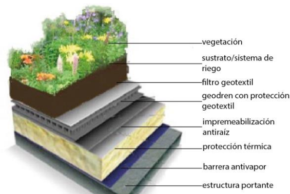
Figura 11: Corte techo verde semi-intensivo. Fuente: Google Año:2019
