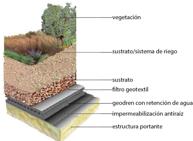
Figura 10: Corte techo verde intensivo Fuente: Google Año: 2019
