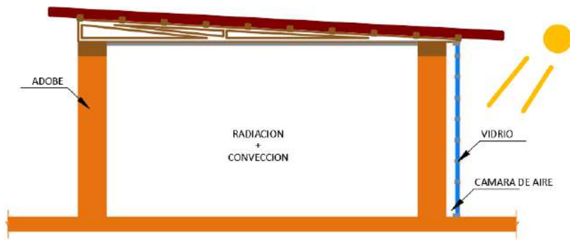
Figura 60 Sistema de muro trombe
