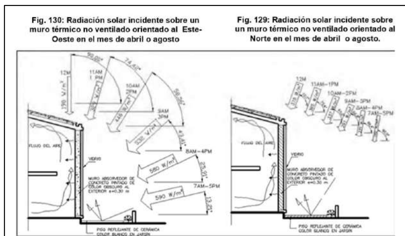
Figura 59: Radiación solar incidente sobre un muro térmico
