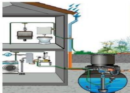
Figura 5. Sistema automatizado de cosecha de agua pluvial
