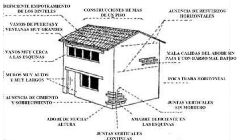
*Figura N° 03* : Esquema de las deficiencias en la construcción de viviendas con adobes
