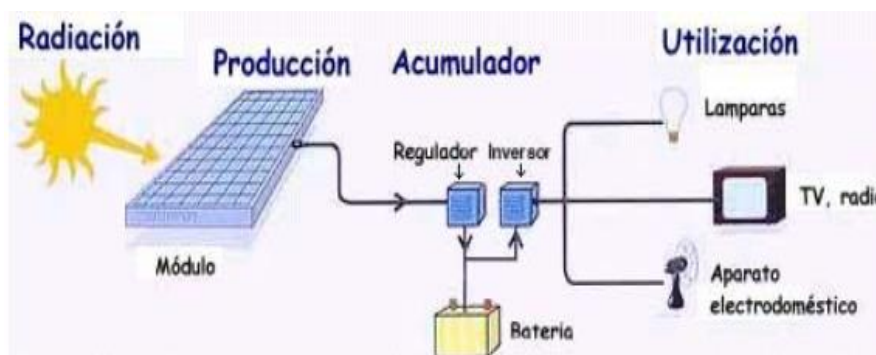
Figura 4: Proceso de un sistema fotovoltaico
