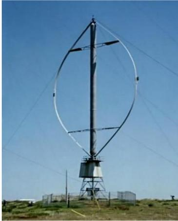
Figura 62. Aerogenerador Tipo Darrieus
