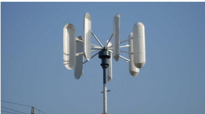
*Figura 61. Aerogenerador Tipo Giromil*
