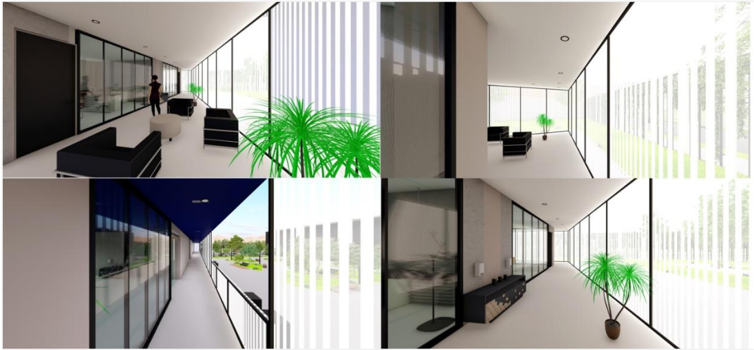
Figura 35. Policarbonato en cerramiento de fachadas.
