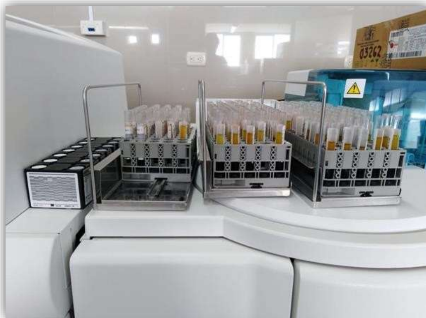
Racks con muestras en equipo Bioquímica Cobas 6000, método Inmuturbidimétrico.
